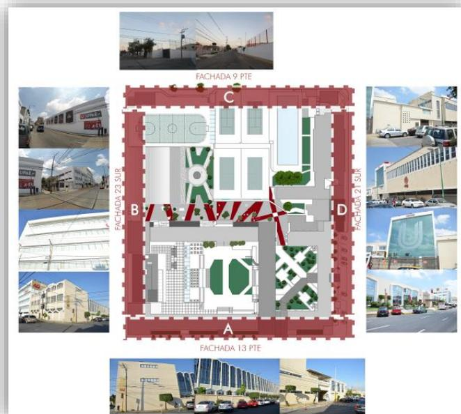
La propuesta general consiste en la incorporación de dobles fachadas sobrepuestas en la estructura original, minimizando intervenciones estructurales y logrando una rápida incorporación de los elementos distintivos. En algunos casos, la cantidad y distribución de los paneles permitirá disminuir los problemas de insolación y ruido que presentan actualmente.
